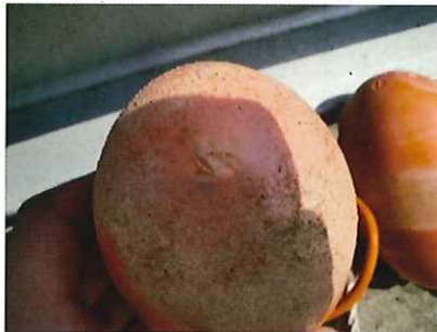
液面制御フロートスイッチ 故障品の交換
